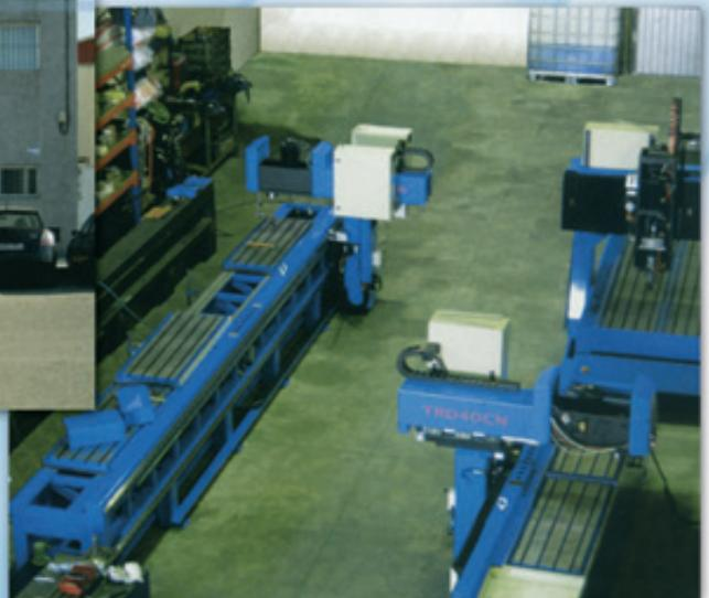
Con el nuevo sistema creado por CMA el cabezal del taladro se desplaza sobre los tres ejes de coordenadas "X, Y, Z" hasta encontrar el punto exacto donde se desea realizar el agujero.
